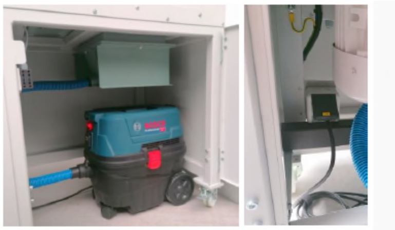
Figura 43. Aspiradora opcional con fuente de alimentación conmutada en la máquina de shredding
